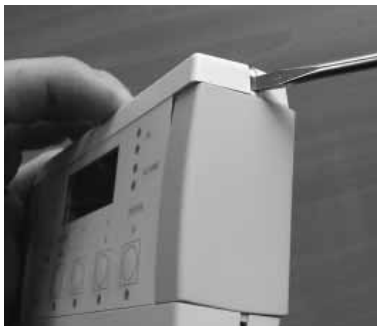
Gebruik een kleine schroevendraaier
