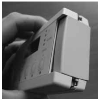
Er zijn 2 openingen voor de bevestiging
