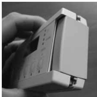
Il y a 2 clips de chaque côté du boîtier
