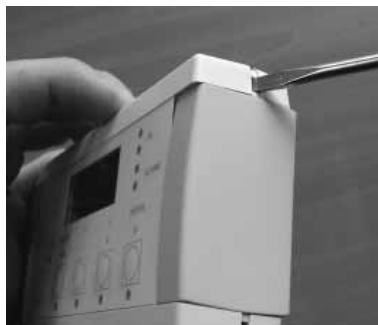
Déclipser le couvercle à l'aide d'un fin tournevis
